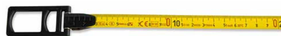
**BM 50 W:** стальная измерительная лента с белым лакокрасочным покрытием и делением в сантиметрах и миллиметрах. Нулевая отметка шкалы на элементе крепления ленты. Класс точности II.
