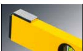
Тип 70 P-2-2 идеально подходит для создания конструкций из деревянных стоек, установки готовых стеновых и сборных бетонных конструкций, конструктивных элементов и системных опалубок. Измерительная **поверхность с двумя вмонтированными накладками** перекрывает неровности материала и позволяет провести точные измерения, например на бракованной балке.
