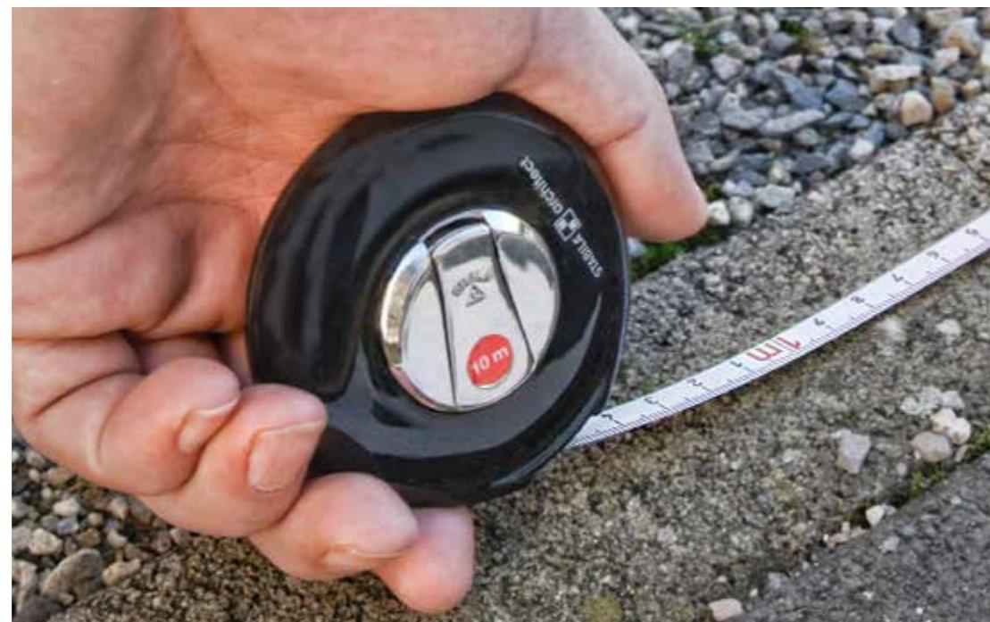
**BM 50 G:** легкая и износостойкая измерительная лента с делением в сантиметрах (первый метр с делением в миллиметрах). Пластиковое покрытие для защиты шкалы от истирания. Нулевая отметка шкалы на элементе крепления ленты. Класс точности III.
