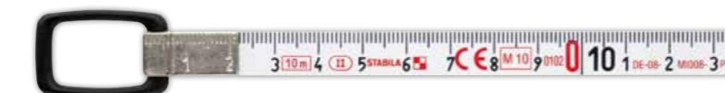
**ARCHITECT:** стальная измерительная лента с белым лакокрасочным покрытием и делением в сантиметрах и миллиметрах. Нулевая отметка шкалы на элементе крепления ленты. Класс точности II.
