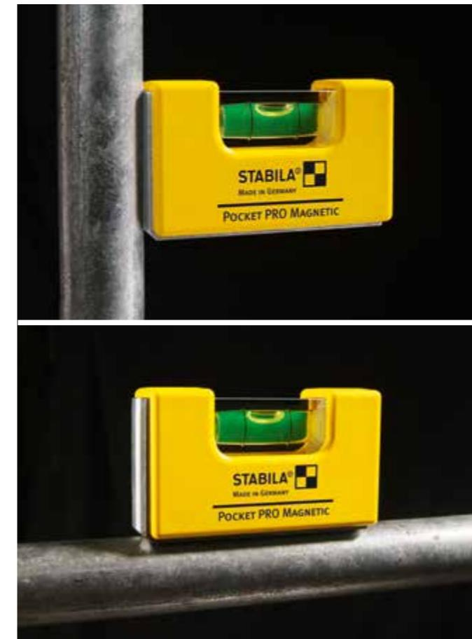
**Pocket PRO Magnetic:** небольшой размер и прочный прямоугольный корпус из алюминия. Две точно отфрезерованные измерительные поверхности с U-образной канавкой для измерений по горизонтали и вертикали и мощные редкоземельные магниты на нижней и боковых измерительных поверхностях. Отлично подходит для измерительных работ при строительстве металлоконструкций. Идеальный дополнительный инструмент для всех специалистов.
