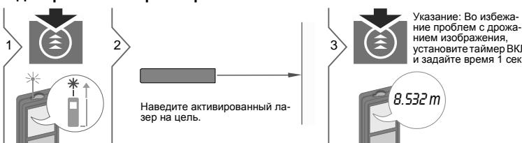
Целевые поверхности: Ошибки при измерениях могут возникнуть в случае выполнения измерений до таких поверхностей, как бесцветные жидкости, стекло, стирофор, матовые полупрозрачные поверхности или при наведении на очень блестящие поверхности. При наведении на темные поверхности время измерения увеличивается.
