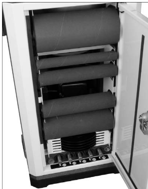
Рис. 3: хранение принадлежностей в тумбе станка
