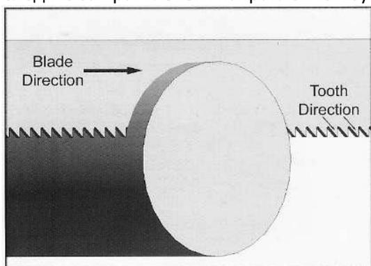
При недостаточном натяжении полотно будет уводить с линии реза, заклинивать в заготовке и проскальзывать на шкивах. При слишком большом натяжении полотно может разрушиться.
