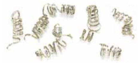
Свободно намотанная (витая) стружка идеальные условия резания
